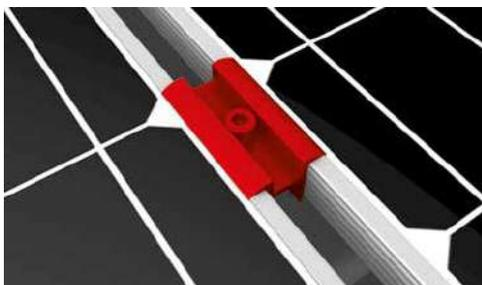
Entre deux modules utiliser deux étriers intermédiaires universels OneMid. Clipser l'étrier dans la rainure du rail et fixer l'étrier au cadre du module.
