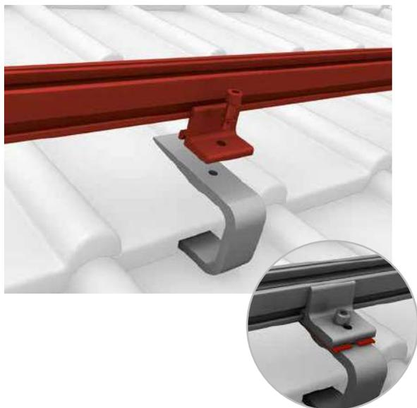
Le Rail de montage est fixé sur le crochet à l'aide du Climber K2. Couple de serrage 16 Nm.
